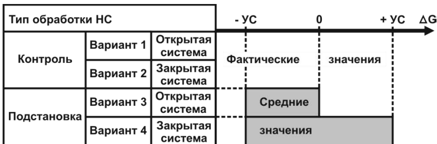
Рисунок 3.32 – Алгоритм работы вычислителя для различных вариантов значений параметра Тип контроля
