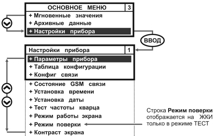
Рисунок 1.1 – Развёрнутое изображение меню Настройки прибора
